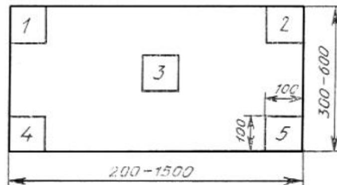
Допускается проводить испытания по коэффициенту отражения на готовых изделиях площадью более 0,06 кв.м.
