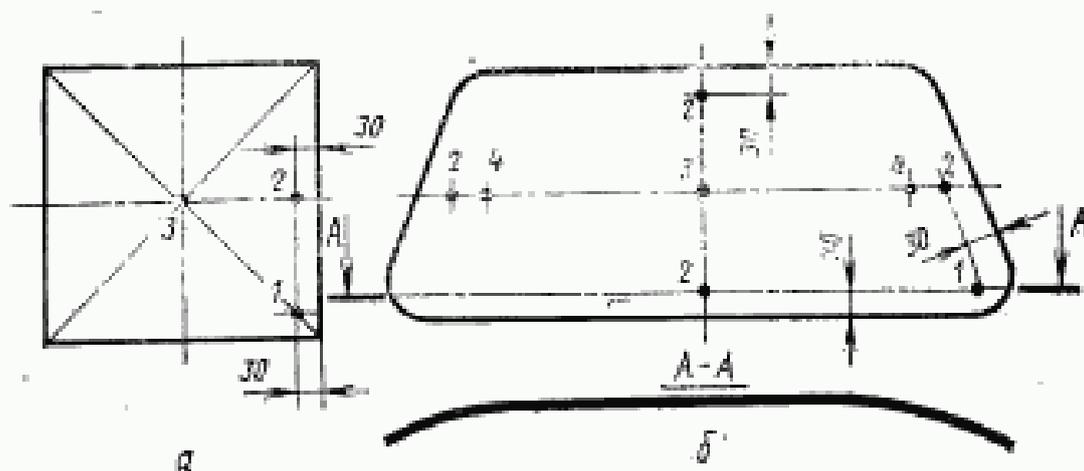
Точка 1 — в 30 мм от края в одном углу (в наиболее остром углу на образце неправильной формы); точка 2 — в 30 мм от края примерно на одной из медий; точка 3 — в геометрическом центре образца (в случае ветрового стекла в основной области обзора); точка 4 — (только для изогнутых стекол) в точке максимальной кривизны на более длинной из медий, удар должен производиться с выпуклой стороны, но если необходимо, то с вогнутой
